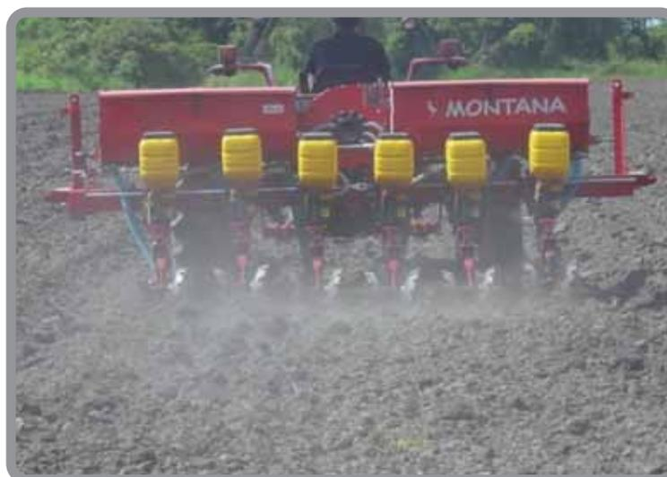
**Figura 55.** Sembradora grano grueso. Tomado de: <http://www.maquinariamontana.com/images/stories/montana/fotos/GG/Image00004.jpg>
