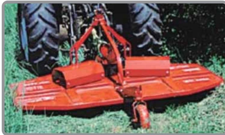
**Figura 50.** Guadaña para tractor (cortadora rotativa). Tomado de: [http://www.tatu.com.ve/Cortadoras\\_rotativas\\_RO2600.html](http://www.tatu.com.ve/Cortadoras_rotativas_RO2600.html)
