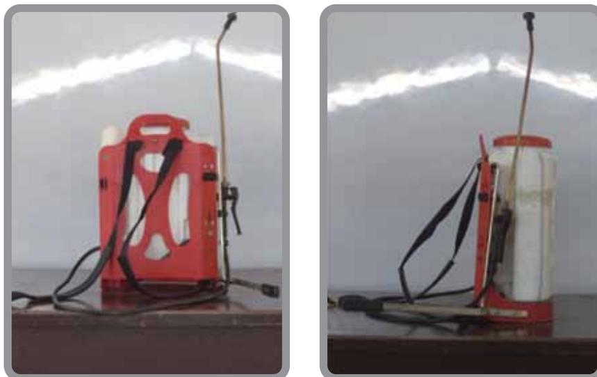
Figura 58. Equipo de palanca o presión hidráulica.
