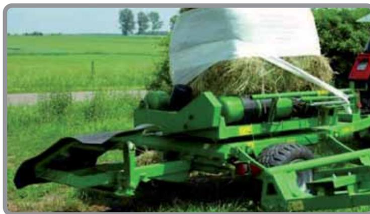
**Figura 93.** Envoltura de un fardo. Tomado de: <http://www.interempresas.net/Agricola/FeriaVirtual/Producto-Encintadora-autonoma-Z-245-59153.html>
