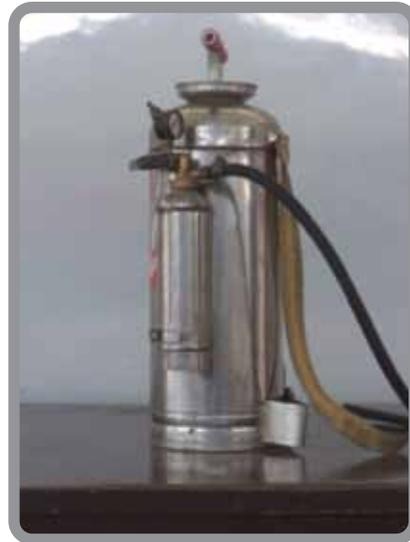
**Figura 59.** Equipo de presión constante (neumática)
