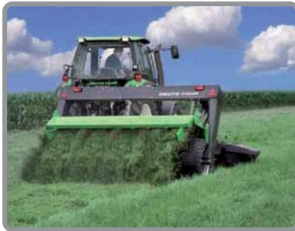
**Figura 99.** Segadora acondicionadora en campo. Tomado de: <http://www.hnosotal.com/2009/02/segadoras-de-discos-kverneland-group.html>
