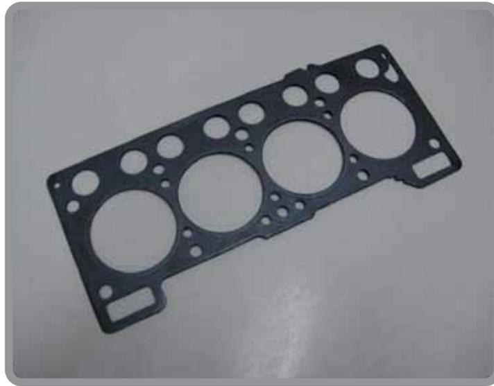
**Figura 4.** Junta o empaque de culata.
