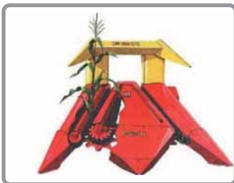
**Figura 86.** Cabezal cortador de recolector de maíz. Tomado de: Villa, 2000.
