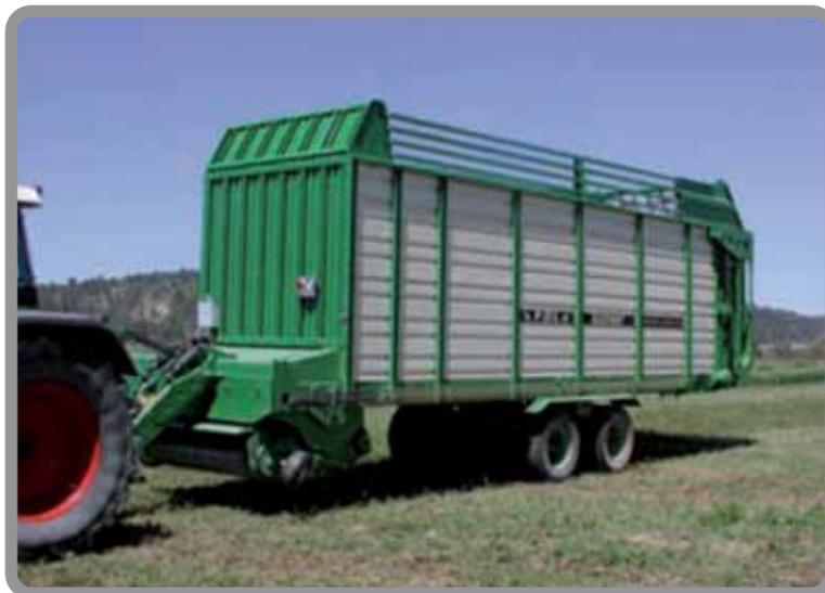
**Figura 68.** Recolector de pasto previamente hilerado. Tomado de: <http://www.mundoganadero.es/articulos-maquinaria-para-recoleccion-forraje-para-alimentacion/1/1688.html>
