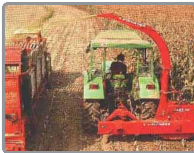
**Figura 88.** Cosechadora de forrajes para una hilera de maíz. Tomado de: Villa, 2000.
