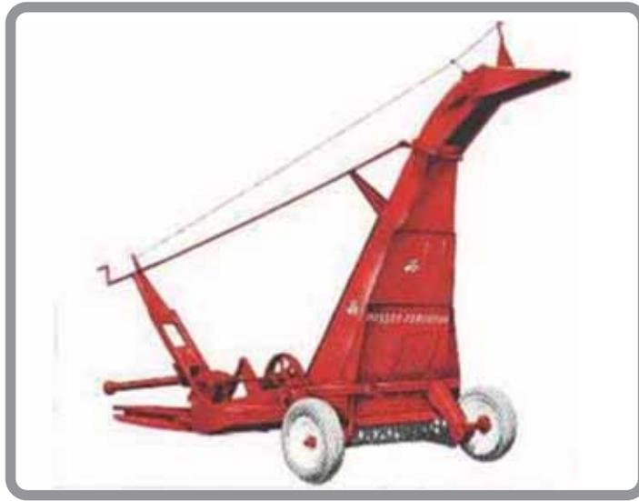
**Figura 73.** Estructura de descarga de una cosechadora de corte simple.
