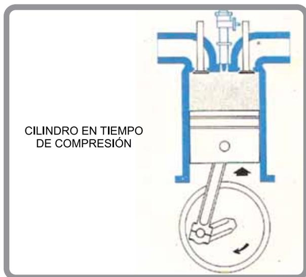
**Figura 16.** Esquema de un cilindro en tiempo de compresión.
