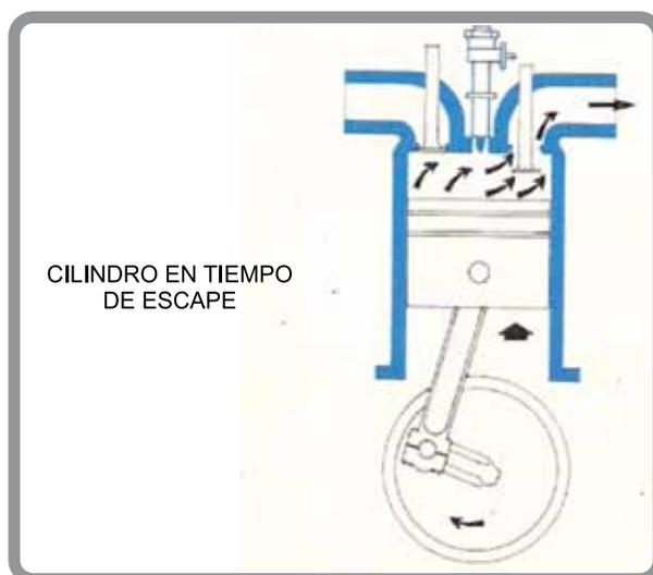
**Figura 18.** Esquema de un cilindro en tiempo de escape. Tomado de: Arnal y Laguna (1980).
