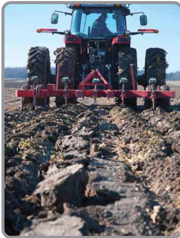
**Figura 47.** Corte y fracturación del suelo por cincel. Tomado de: <http://www.agyours.com/agfr/?portfolio=arado-cincel&lang=es>.
