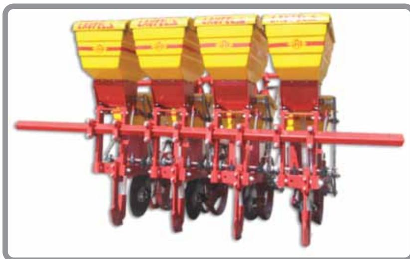
Figura 57. Fertilizadora en bandas o surcos. Tomado de: [http://www.arisa.com.mx/jas\\_html.html](http://www.arisa.com.mx/jas_html.html)
