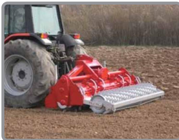
**Figura 45.** Trabajo de campo con conformador de superficie (packer). Tomado de: [http://www.hellopro.es/HOWARD\\_IBERICA\\_S\\_A\\_-7703-noprofil-2005307-16126-0-1-1-fr-societe.html](http://www.hellopro.es/HOWARD_IBERICA_S_A_-7703-noprofil-2005307-16126-0-1-1-fr-societe.html)
