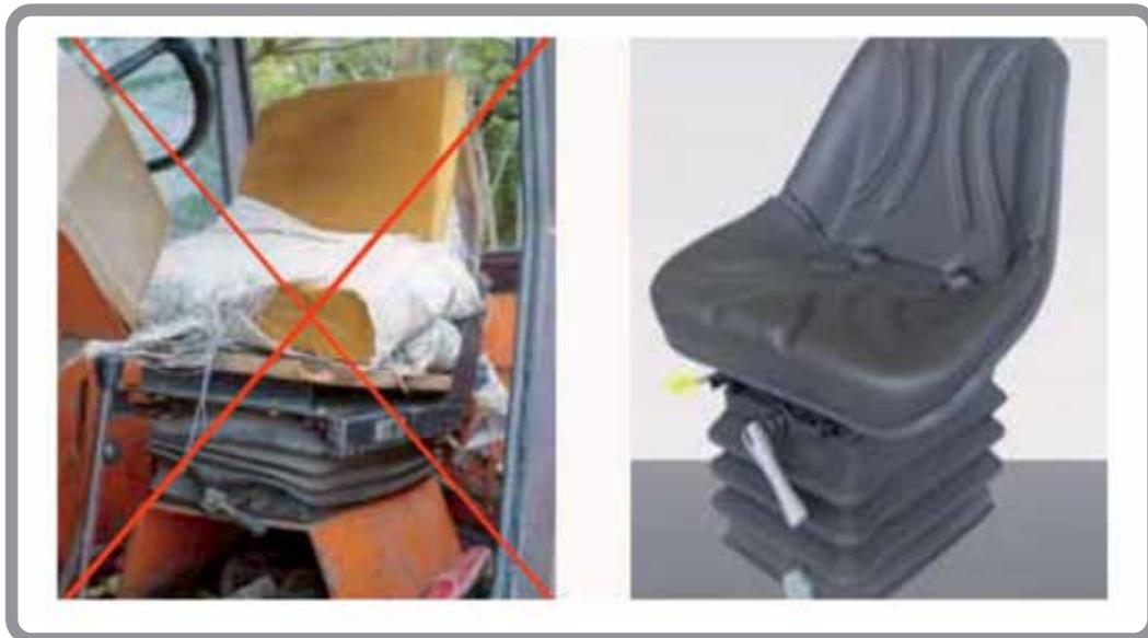
**Figura 120.** Figura 122. Una adecuada silla evita la fatiga y a mediano plazo problemas físicos en el operador. Tomado de agro consultar (2011).
