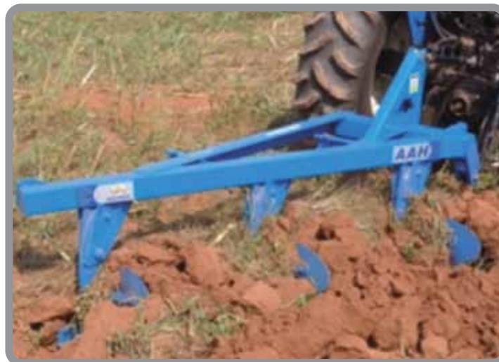
**Figura 38.** Inversión del prisma de suelo por arado de vertedera. Tomado de: <http://www.viarural.com.co/agricultura/maquinaria-agricola/tatu-marchesan/arados-rastras/arados-de-vertedera-helicoidal-01.htm>
