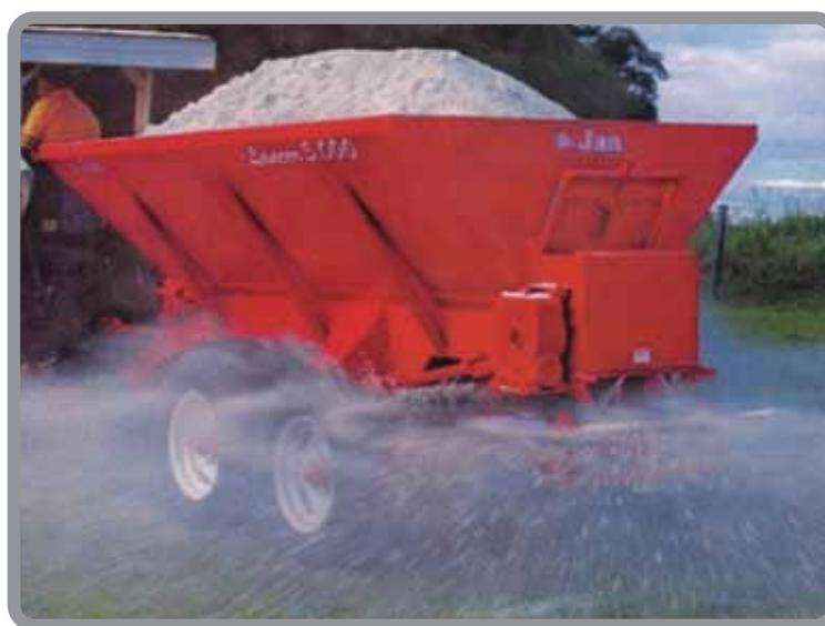
**Figura 56.** Fertilizadora al voleo. Tomado de: <http://www.pasturasyforrajes.com/pastura-base-treboles/fertilizacion-de-la-pastura/fertilizacion-en-implantacion-2>
