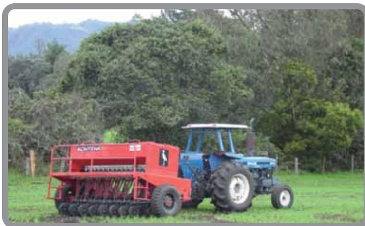
**Figura 53.** Sembradora de grano fino. Tomado de: <http://www.maquinariamontana.com/images/stories/montana/fotos/GF/Image00002.jpg>
