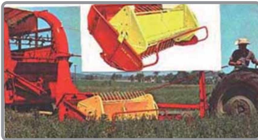
**Figura 84.** Cabezal de barra segadora de cultivos en pie. Tomado de: Villa, 2000
