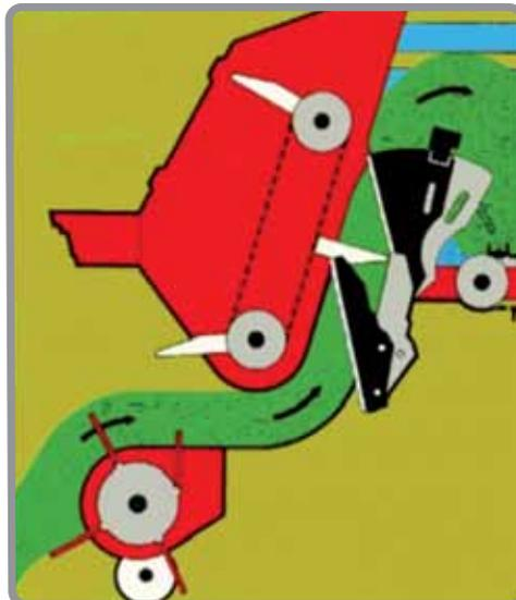
**Figura 71.** Mecanismo alimentador de ensiladora estacionaria. Tomado de: <http://www.marm.es/app/mecanizacion/fichamaquinaria.aspx?n1=7&n2=1&n3=4&n4=0>
