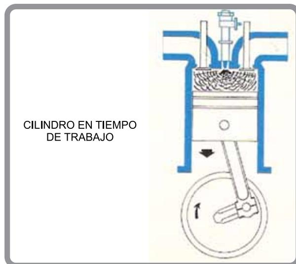
**Figura 17.** Esquema de un cilindro en tiempo de trabajo. Tomado de: Arnal y Laguna (1980).
