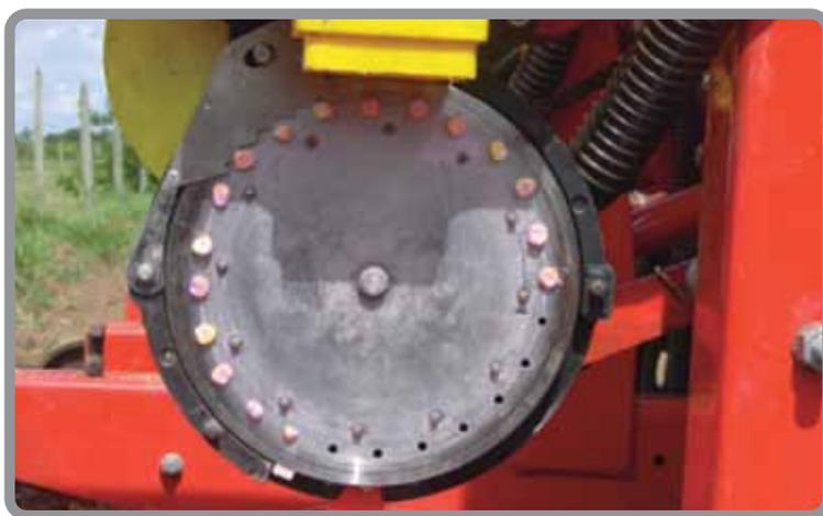
**Figura 54.** Dosificación de semilla en sembradora de grano grueso. Tomado de: <http://www.maquinariamontana.com/sembradora-grano-grueso>
