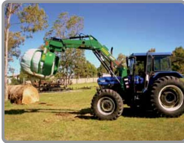
**Figura 95.** Manejo de las pacas con un cargador frontal.
