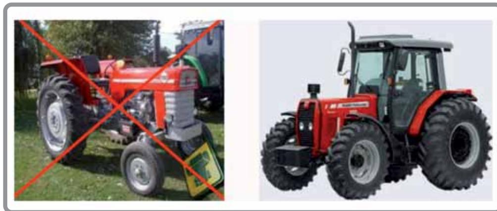
**Figura 121.** El tractor cabinado (derecha) presenta la mejor condición para proteger al operador del ruido excesivo. Tomado de agro consultar (2011).
