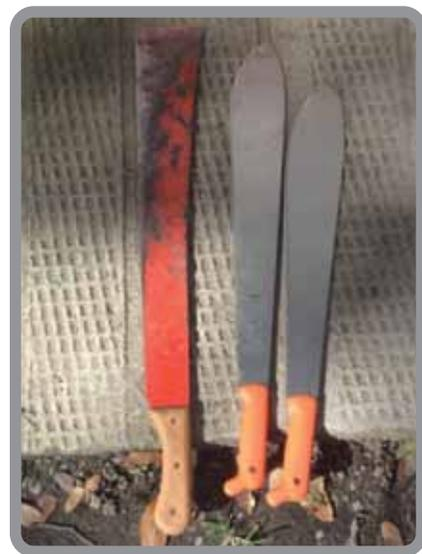
**Figura 48.** Guadaña de espalda (izquierda) y machetes de distinta forma y longitud de hoja de corte (derecha).
